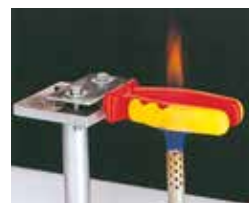
Prova alta temperatura, resistenza alla fiamma. High temperature test, flame retardant test.
