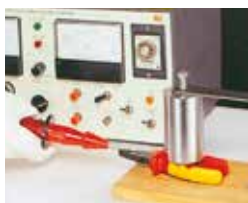
Prova di pressione. Indentation test.
